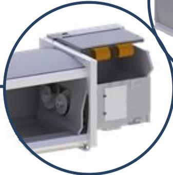
Der Abfall wird durch dem Ausstossschild aus den Aufbau gedrückt
